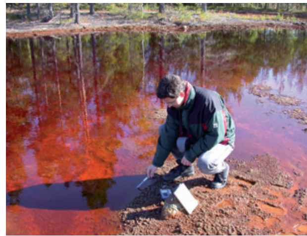
Abb. 7: Messungen an sauren Grubenwässern
