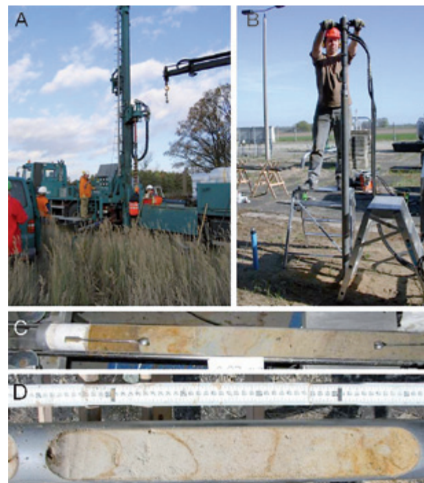
Abb 14: Kernbeprobungen im Gasfeld zum Monitoring
